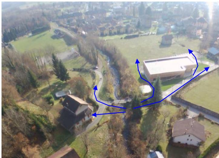
A ce niveau, et ce jusqu'au pont de la rue de l'Eglise, le torrent dispose d'une pente limitant de gros dépôts. Le lit y est relativement large et assez encaissé pour envisager des débordements. Notons que le pont précité peut être le siège d'embâcles qui occasionneraient des débordements avec des écoulements vers le gymnase et dans la parcelle agricole située en aval.
