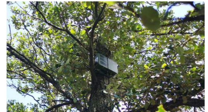
☞ Photographies 39, 40, 41 et 42 : Enregistreurs SMBat mis en place sur un site d'étude
