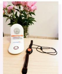
Celui-ci est composé d'un boîtier transmetteur et d'un médaillon déclencheur. Étanche, porté en permanence par l'adhérent en bracelet ou en collier, une pression sur l'unique bouton du médaillon envoie un appel à la centrale. Relié à la prise téléphonique et au secteur, le boîtier transmetteur permet de dialoguer avec l'opérateur de téléassistance grâce à son micro très puissant et à son haut-parleur.
