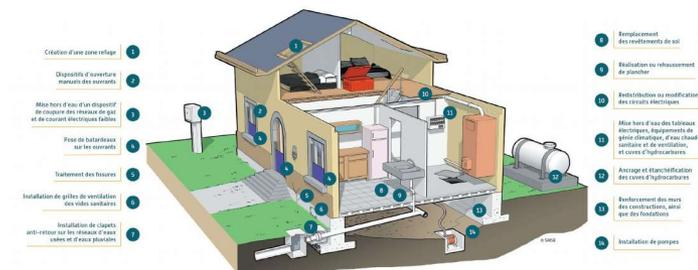
Moyens de protections individuelles permettant de réduire la vulnérabilité d'une habitation au risque inondation (source © SMBVG - guide de réduction de la vulnérabilité publié en 2020)
