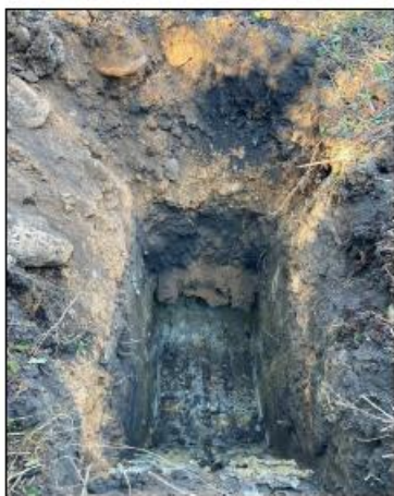
Fouilles dans le cadre de l'étude géotechnique ingésol
