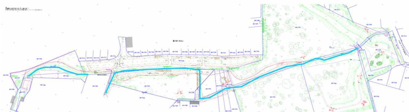
Figure 1 : En bleu turquoise, le tracé actuel du Vaularon aux Grand Prés complètement dénaturé par l'urbanisation et le rendant rectiligne avec des berges verticales et érodées.
