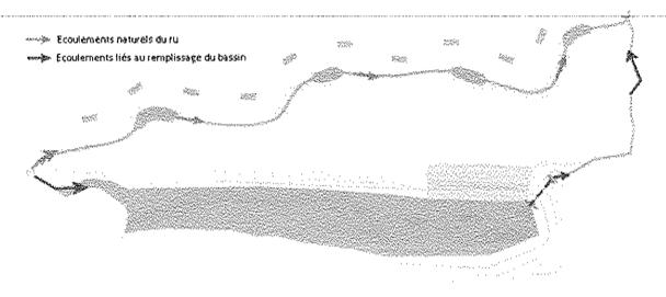
Situation en crue supérieure ou égale à 20 ans : dans cette situation de crue supérieure à la vicennale, la capacité de stockage du bassin est totalement mobilisée. Le débit de fuite est saturé. Le bassin déborde alors par le dispositif de surverse aménagé en aval sur sa façade Ouest
