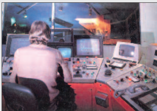
Début des années 1970 : l'aciérie de Gandrange à la pointe de la modernité. Emploi de l'ordinateur IBM de centralisation des mesures et contrôles, avant envoi-visualisation des informations et ordres sur les différents pupitres en cabines des postes de travail
