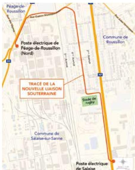
Pour assurer durablement l'alimentation électrique de la zone de Roussillon, RTE renouvelle une liaison souterraine électrique à 63 000 volts. D'une longueur de 2 km, le futur ouvrage reliera le poste électrique de Salaise à celui de Péage de Roussillon Nord, en remplacement de la liaison mise en service en 1954. Les travaux se déroulent depuis février jusqu'en
