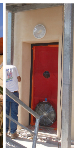
Etanchéité à l'air
