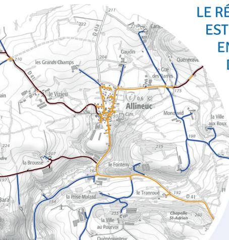
► Dans l'exemple ci-contre, on peut voir la cartographie partielle des infrastructures sur la commune d'Allineuc (22). Le centre bourg est couvert par un réseau en sous-terrain
