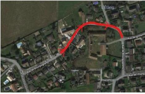
Nous allons poser les panneaux de chaque côté, réduire la voie de circulation de voiture et des bus, matérialiser une voie piéton-vélo et repositionner les deux coussins berlinois (un en entrée de zone et un en sortie).
