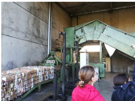
La machine "wall e" qui compacte les cartons
