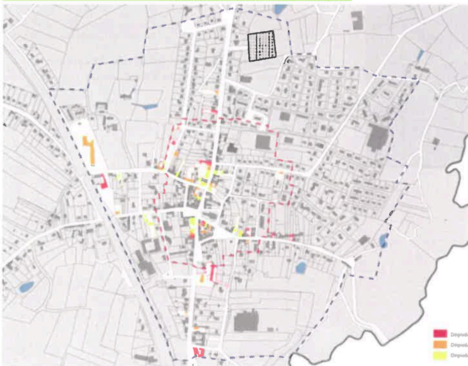
Le niveau de dégradation du bâti en centre-bourg (repérage terrain)
