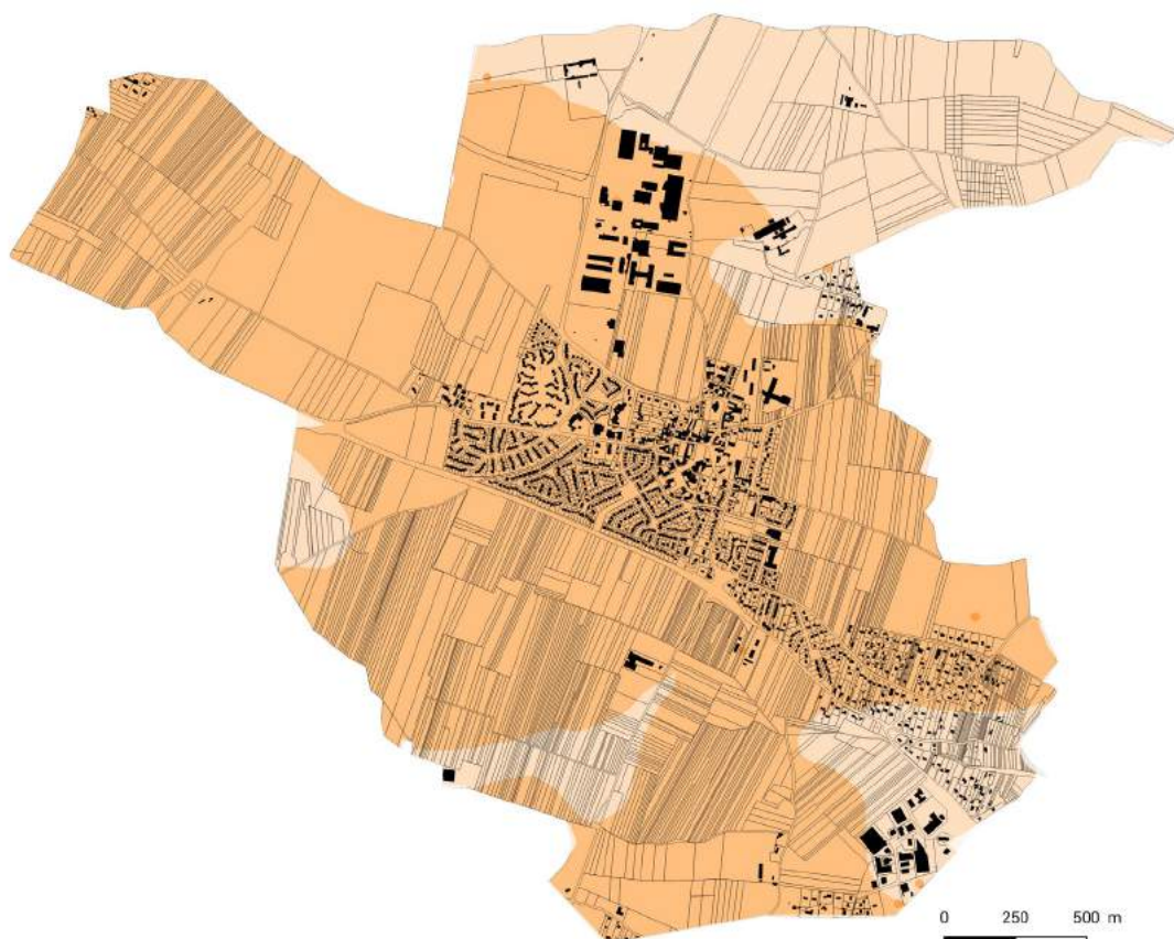
Fig. 54. L'aléa retrait-gonflement des argiles sur le territoire de Nozay
