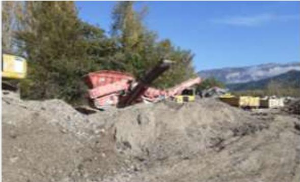
Criblage de la fraction fine (0-30 mm)
