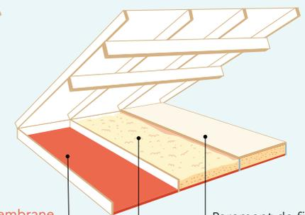
Isolant en vrac, injecté sous pression
