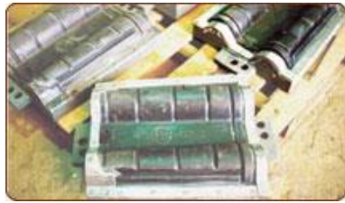
Ce dernier, coupé en galettes, est pressé selon le modèle à fabriquer.
