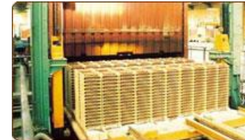
La tuile préformée, dite «tuile verte», regorgeant d'eau, passe au séchage
