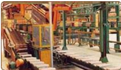
Ce dernier, coupé en galettes, est pressé selon le modèle à fabriquer.
