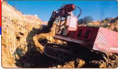
L'argile nécessaire à la fabrication des tuiles est extraite à ciel ouvert
