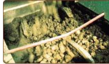
L'argile est ensuite additionnée d'eau pour permettre sa mise en forme.
