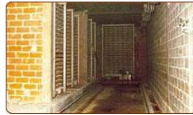
La tuile préformée, dite «tuile verte», regorgeant d'eau, passe au séchage
