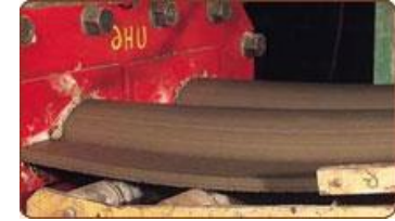
Vidé sous haute pression d'une grande partie de l'air, un ruban de terre préformé sort de la filière.
