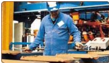
Une fois les tuiles cuites, elles sont ôtées de leurs supports, subissent un contrôle visuel et sonore individuel, et sont acheminées vers l'aire de
