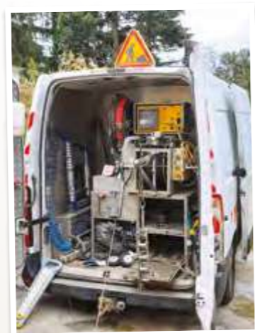
Véhicule de commandement avec géolocalisation de tous les branchements, avec monitor de contrôle, caméra, guidage du robot
