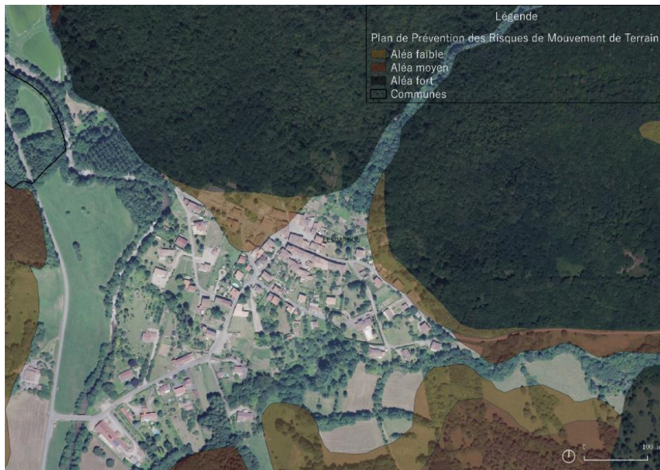
Carte représentant le risque de mouvement de terrain sur la commune de Lesparrou
