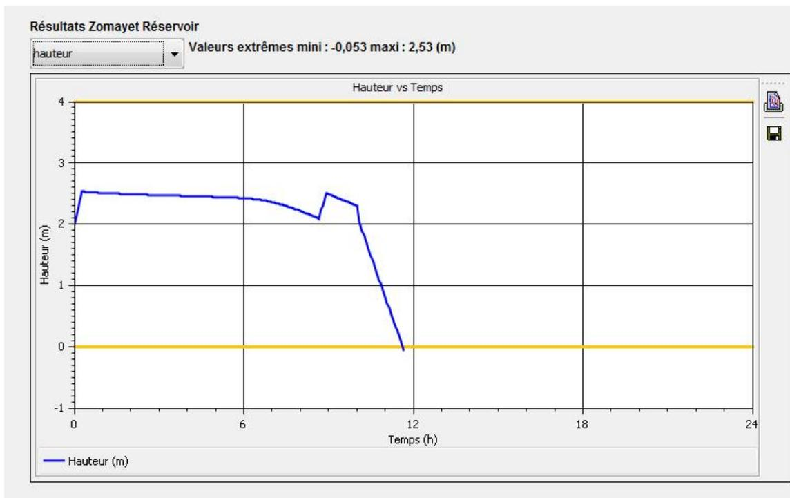
Figure 19 : Marnage du réservoir du duret en cas d'ouverture d'un poteau incendie dans le Bourg
