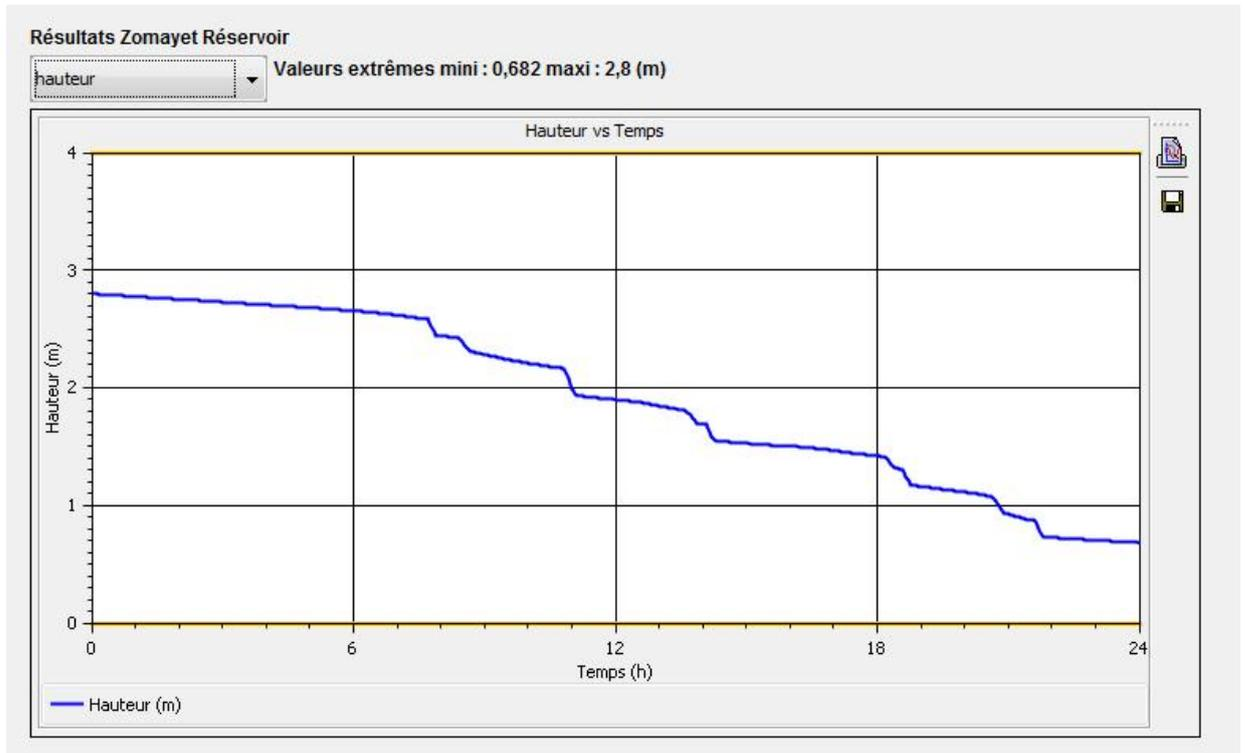
Figure 22 : Courbe de marnage du réservoir de la Gérinière en cas de panne de 24h de l'alimentation
