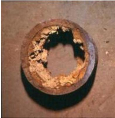
Figure 10 : Exemple de canalisation en fonte soumise à corrosion interne
