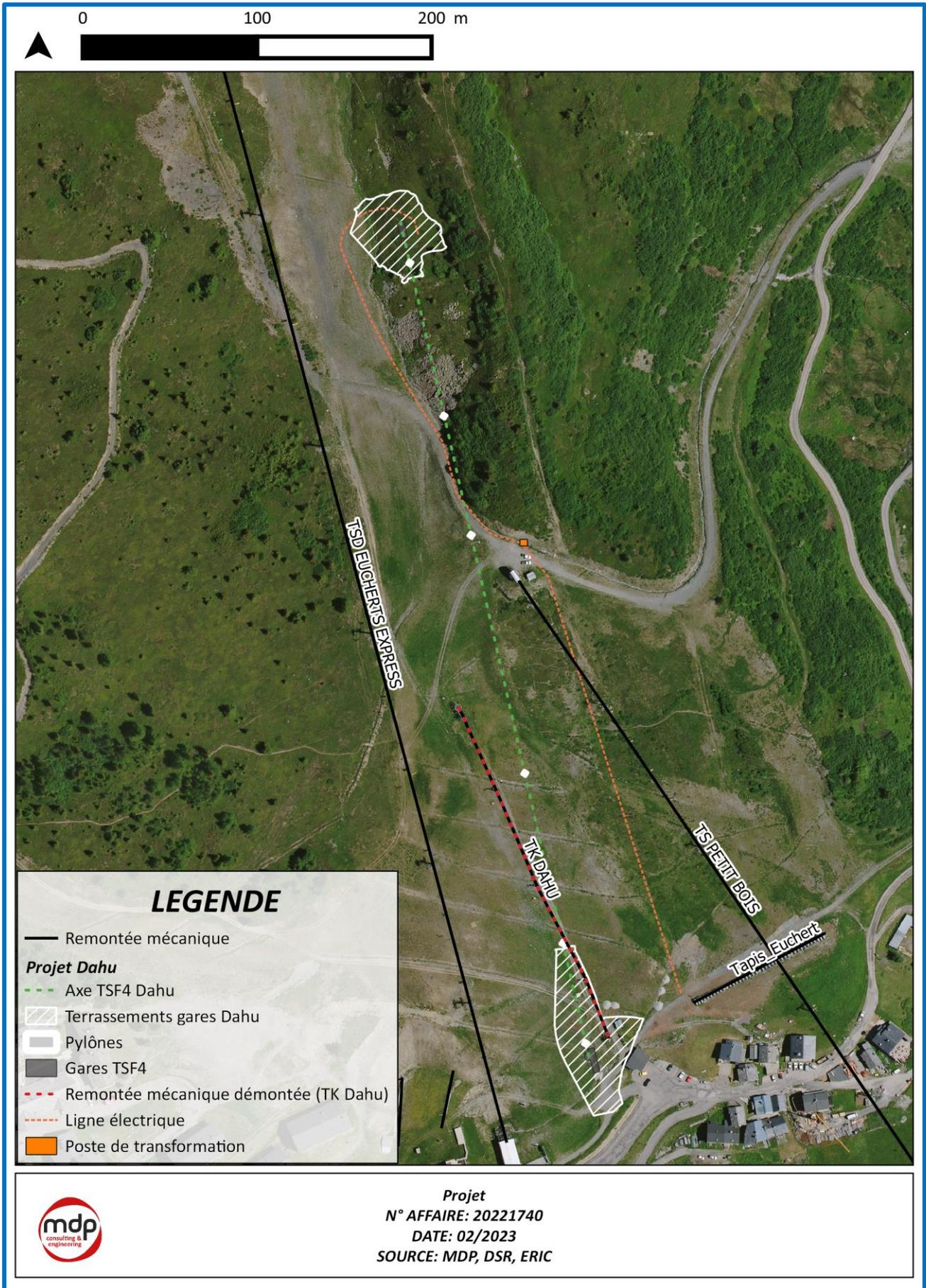
La ligne électrique de 600 mètres de longueur sera enterrée. Au total, la tranchée pour l'enfouissement de la ligne aura une largeur de 1,5 mètre et une profondeur de 2 mètres.
