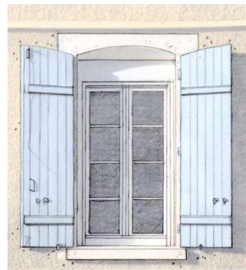
La fenêtre en PVC avec volet roulant incorporé est inadaptée à cette façade soigneusement rénovée ayant conservé les volets bois traditionnels.
