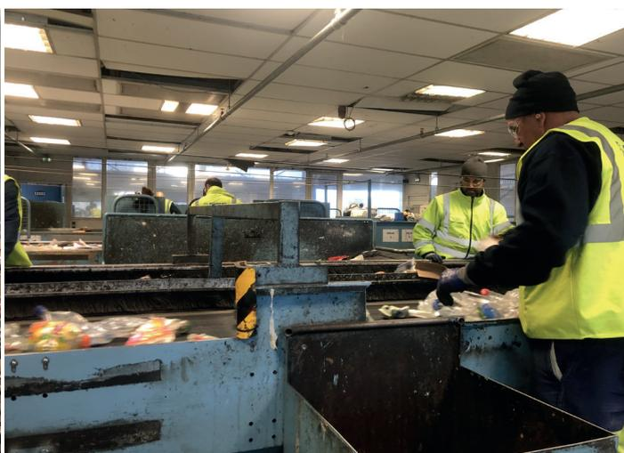
Ces déchets sont acheminés via des tapis roulants afin d'être triés à la fois mécaniquement et manuellement.
