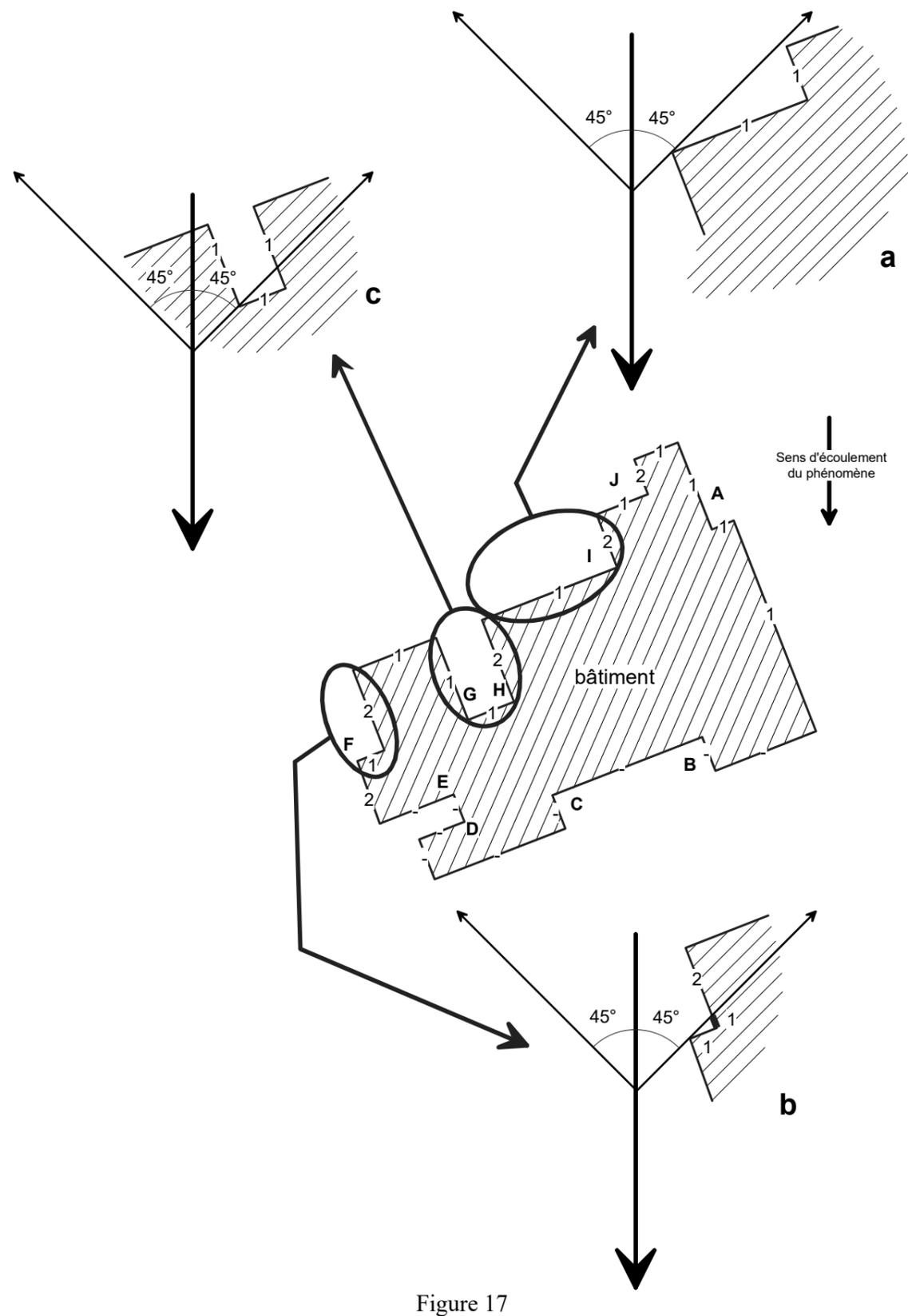
On voit sur la figure 17a que la façade de classe 2 est située «sous» la droite oblique. Cette façade est incluse dans la zone d'accumulation de matériaux contre la façade de classe 1. Elle pourra donc être soumise à des contraintes équivalentes à celles de la façade de classe 1. **La façade initialement de classe 2 sera donc «reclassée» en 1.**
