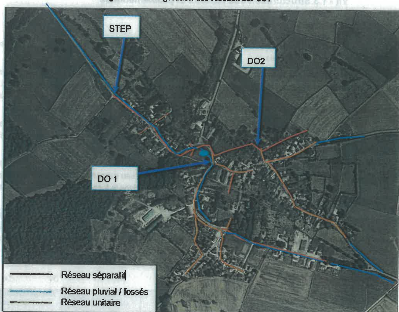
Figure 19 : Configuration des réseaux sur USY
