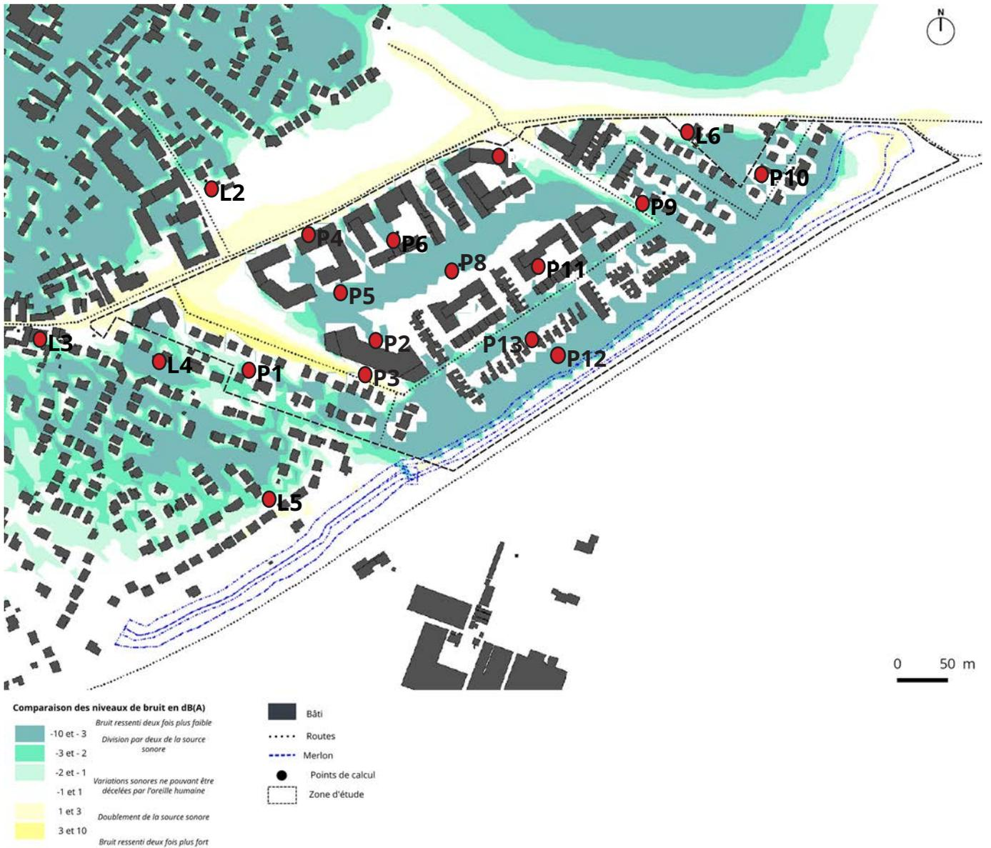
Comparaison des niveaux sonores calculés à 4 m de hauteur - Fil de l'eau et projet - Lden (source TRANS-FAIRE, 2018)
