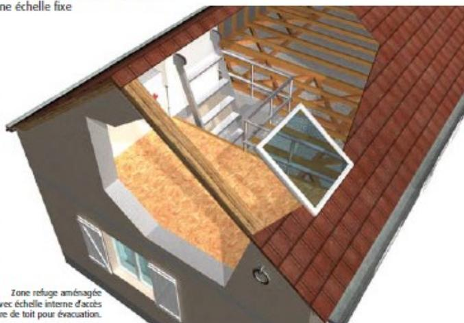
Zone refuge aménagée dans les combles avec échelle interne d'accès et fenêtre de toit pour évacuation.
