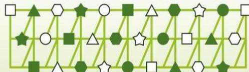
exemple de composition et de disposition d'une haie comportant 10 essences différentes disposées en quinconce à 1 m l'une de l'autre pour une bande de 10 m de long par 2 m de large en forme de trapèze, soit 30 plants
