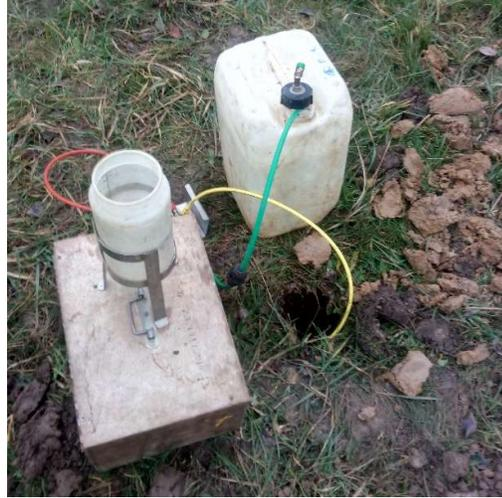
Figure 2.1 : Exemple d'essai Porchet
