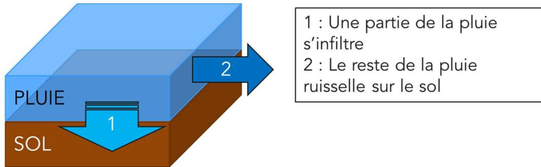
Figure 2.2 : Schéma de principe du ruissellement
