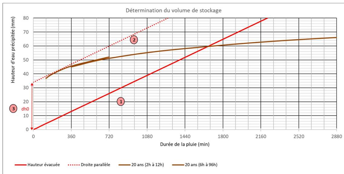
Figure 2.5 : Exemple de détermination du volume de stockage
