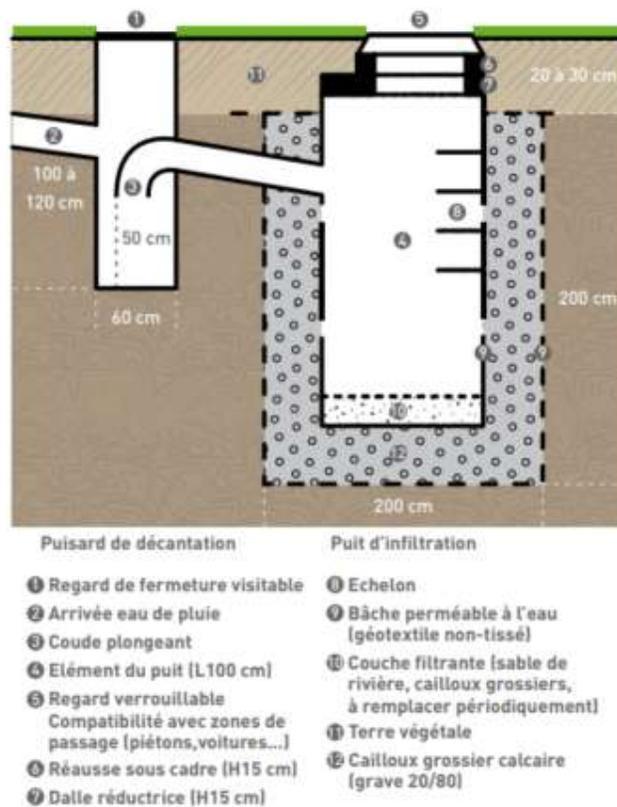
Figure 3.4 : schéma de principe du puits d'infiltration
