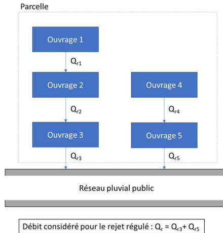
Figure 2.4 : schéma de principe pour les débits régulés
