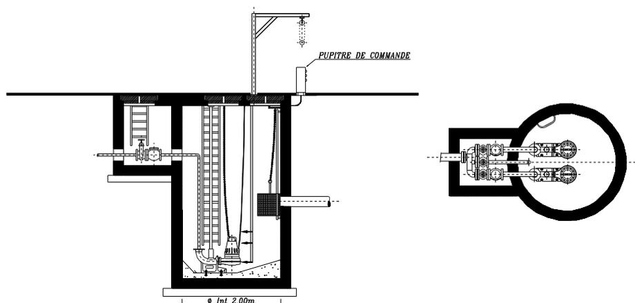
Figure 13 : Schéma d'un poste de refoulement
