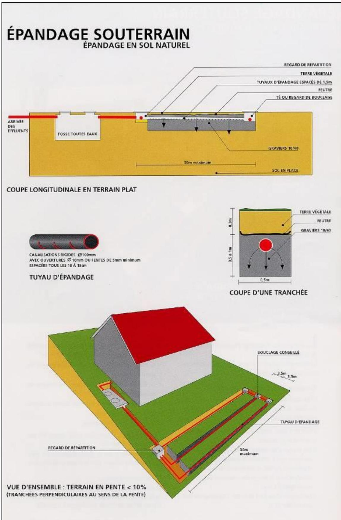
La mise en place d'une filière par épandage sur une parcelle nécessite environ 400 m<sup>2</sup> de terrain libre de tout accès ou réseau (PTT, EDF, AEP).
