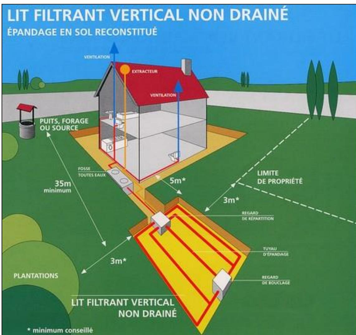
**D**ans le cas où le sol présente une perméabilité insuffisante ou à l'inverse, si le sol est trop perméable (craie), un matériau plus adapté (sable siliceux lavé) doit être substitué au sol en place sur une épaisseur minimale de 0,70 m.
