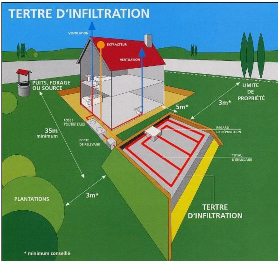
Ce dispositif exceptionnel est à prévoir lorsque le sol est inapte à un épandage naturel, qu'il n'existe pas d'exutoire pouvant recevoir l'effluent traité et/ou que la présence d'une nappe phréatique proche a été constatée.
