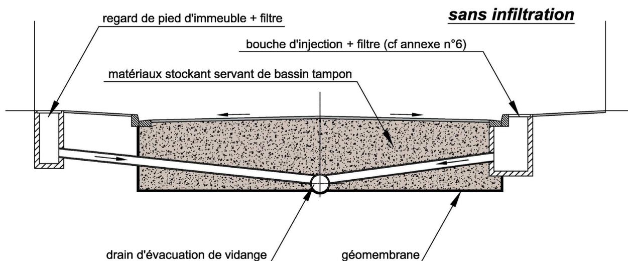
Exemple de chaussée à structure réservoir avec enrobé dense (étanche) et évacuation sans infiltration (Source : CETE Nord - Picardie)
