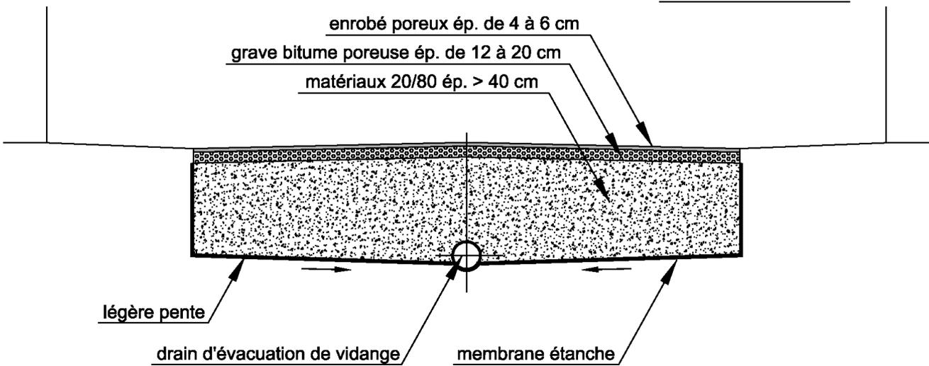
**Exemple de chaussée à structure réservoir avec enrobé drainant et évacuation sans infiltration** (Source : CETE Nord - Picardie)
