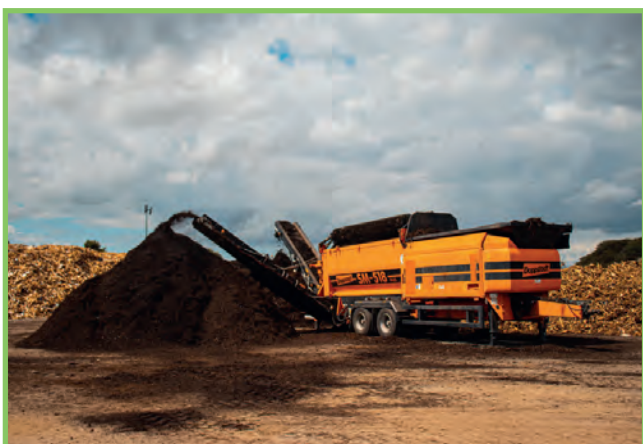
Suite à un mois de fermentation et trois mois de maturation, les déchets verts passent ensuite en étape de criblage
