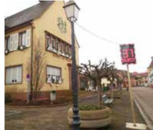
**Radar pédagogique:** ce dispositif doit inciter les usagers en infraction à modifier leur comportement. Résultats d'un premier bilan de l'opération (du 9.11. au 6.12.): 79,44 % de véhicules roulent à plus de 30 km/h et 92 % à moins de 40 km/h. Deux vitesses maximales ont été enregistrées: 89 km/h le 26.11 à 15h18 et 88 km/h le 6.12 à 9h08. La vitesse moyenne est de 29 km/h, ce qui est plutôt rassurant.
