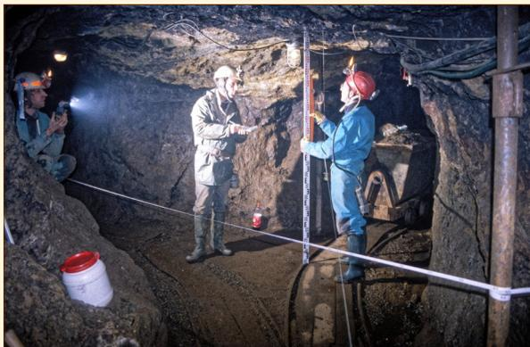
**1998-1999 :** campagnes de relevés très précis (1/20<sup>e</sup>) de la partie initiale de la mine pour tenter de reconstituer le système de transmission de la roue extérieure jusqu'aux pompes du puits d'exhaure.
