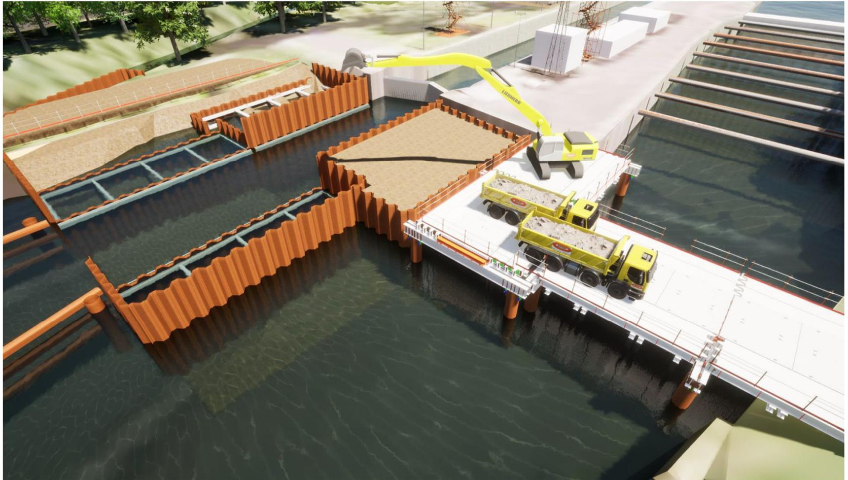
Mise en œuvre des remblais dans les enceintes
