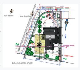
Le plan doit porter son échelle et l'orientation ainsi que les côtes en trois dimensions (longueur, largeur et hauteur).
