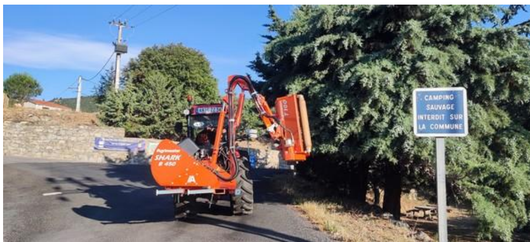
L'épareuse Shark pour les travaux de débroussaillage avec David au volant
