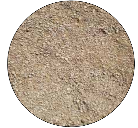
⑤ Poliénas similaire au stabilisé pour cheminement piéton en surface plane sinon concassé
