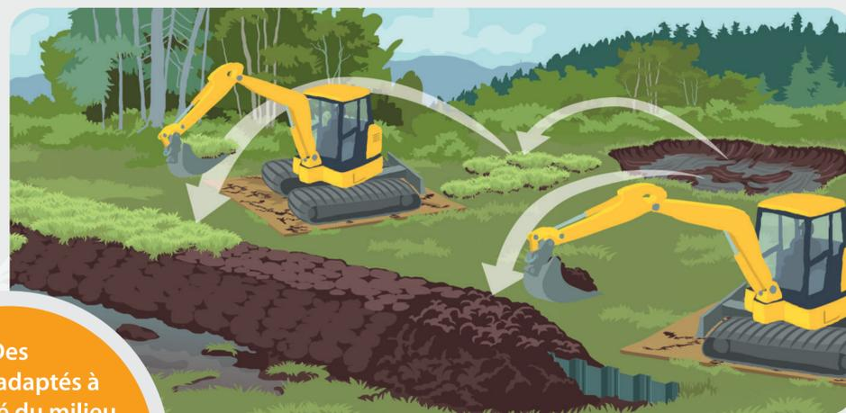
Des merlons de tourbe prélevés sur place ont été créés faisant barrage pour retenir l'eau.
