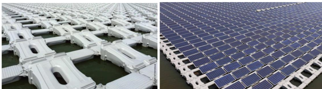
Illustration 9 : Exemple de flotteurs sans et avec panneaux solaires (source AKUO)
