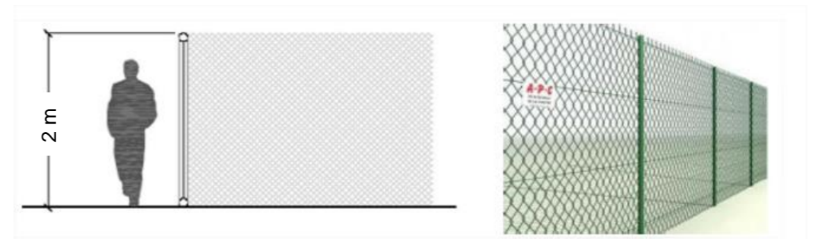
Illustration 20: Exemple de clôture grillagée (vue en coupe et illustration)
