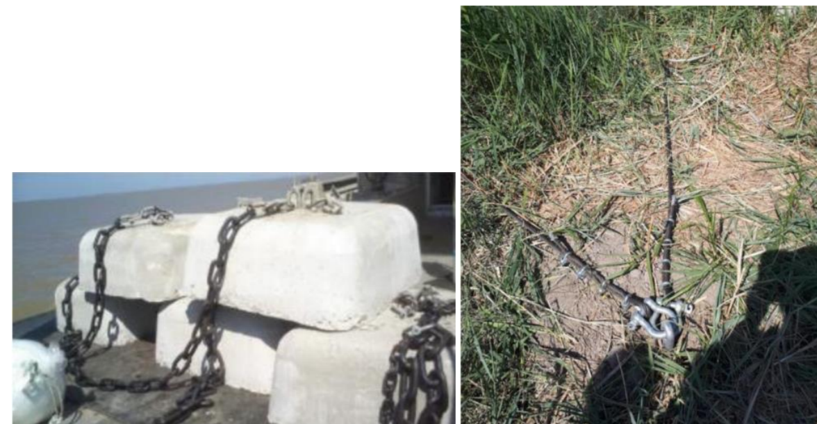
Illustration 10 : Corps mort (gauche), ancre à vis (droite)
