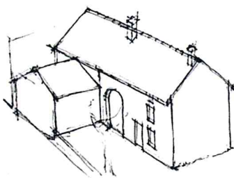
Deux volumes simples implantés perpendiculairement, toitures à 2 pans sans pénétration
