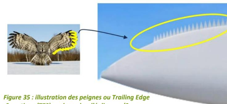
Figure 35 : illustration des peignes ou Trailing Edge Serrations (TES) sur les pales d'éoliennes (Source : OursEole)
