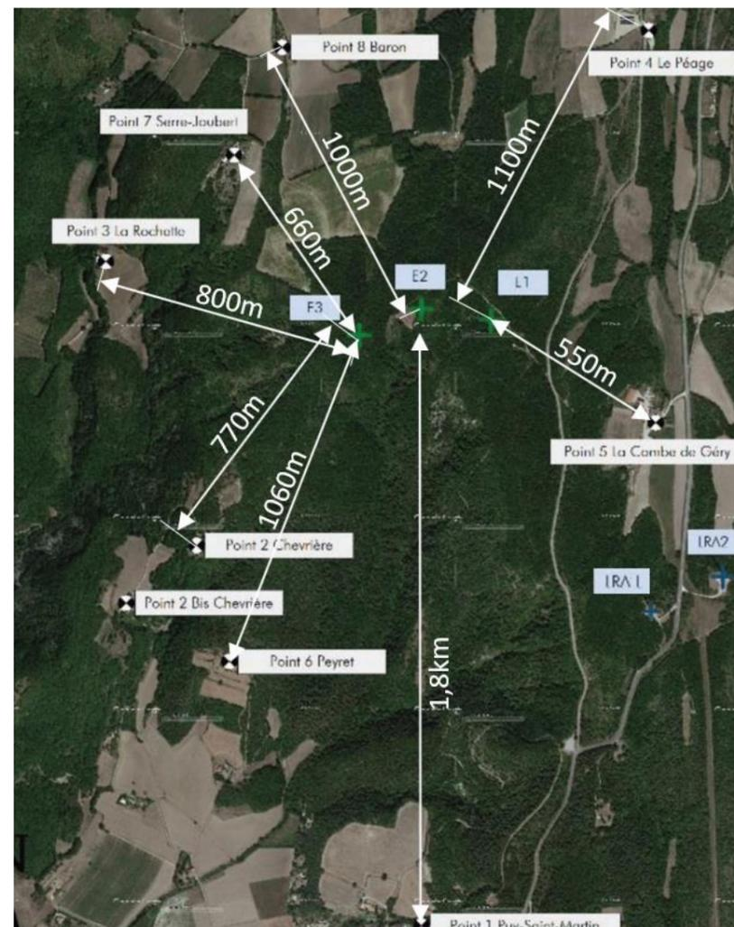
Figure 36 : localisation des points de mesure acoustique, Variante d'implantation V2) (Source : Venathec)
