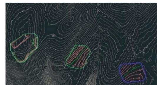
Figure 19 : Représentation sur modèle numérique de terrain (1 m) des plateformes d'éoliennes après optimisation incrémentale des azimuts sous Autocad Civil 3D (Source : Bellane Energie)
