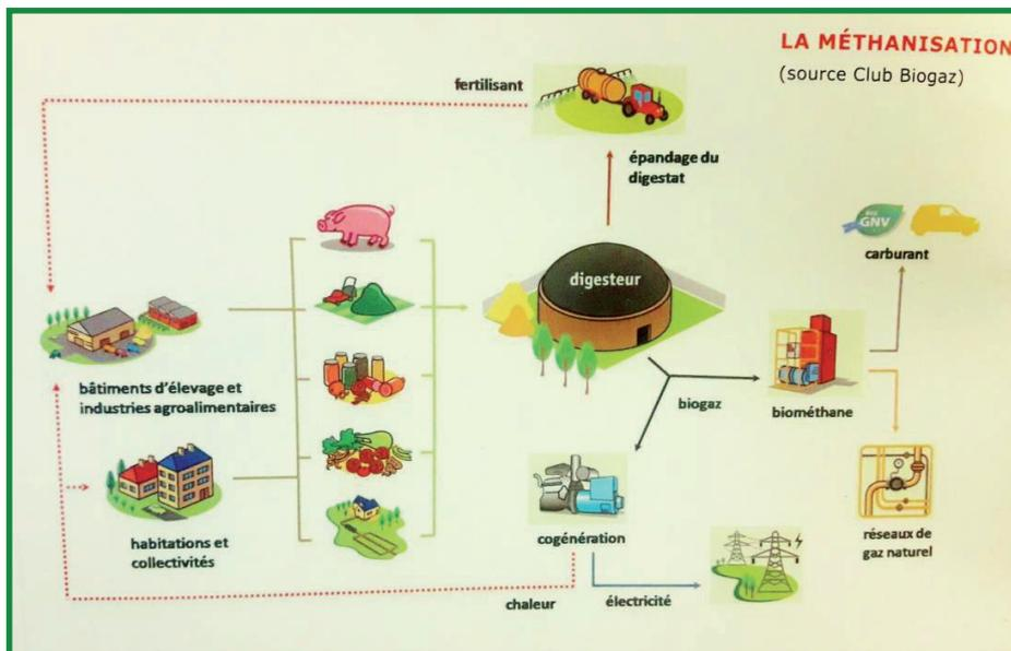
Ce mélange est stocké dans deux cuves appelées digesteurs, le temps suffisant pour en extirper le maximum de méthane. Le gaz produit permet la mise en route d'un moteur de cogénération ; c'est-à-dire que ce moteur fonctionnant au gaz permet de faire tourner une turbine génératrice d'électricité. Nos déchets deviennent donc source d'énergie !
