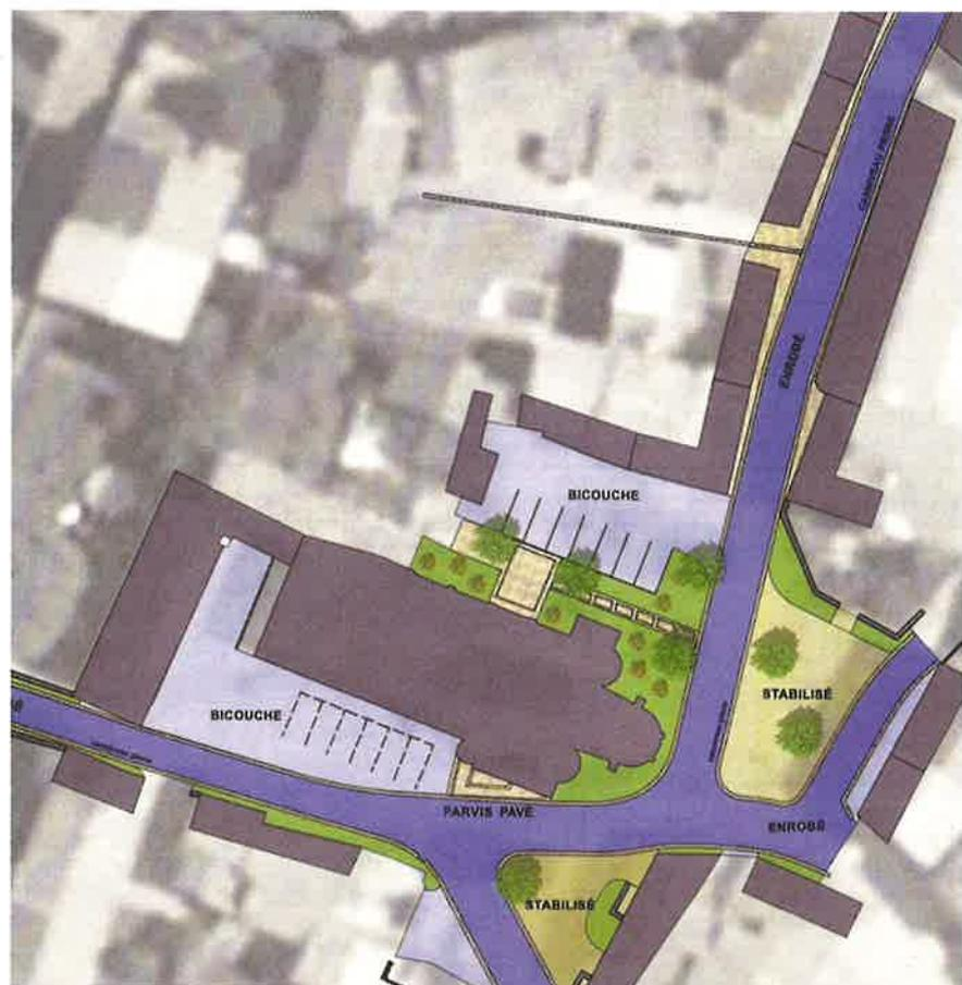
Dans ce périmètre, le principe de plateforme unique est préservé. Une bande centrale en enrobé est délimitée par des caniveaux en pierres.
