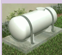
Renforcement du support et de l'ancrage des cuves
