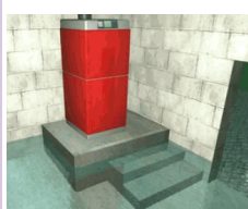
Protection des équipements de chauffage par sur-élévation
