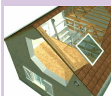
Aménagement d'un espace refuge au-dessus du niveau des PHEC (2)
