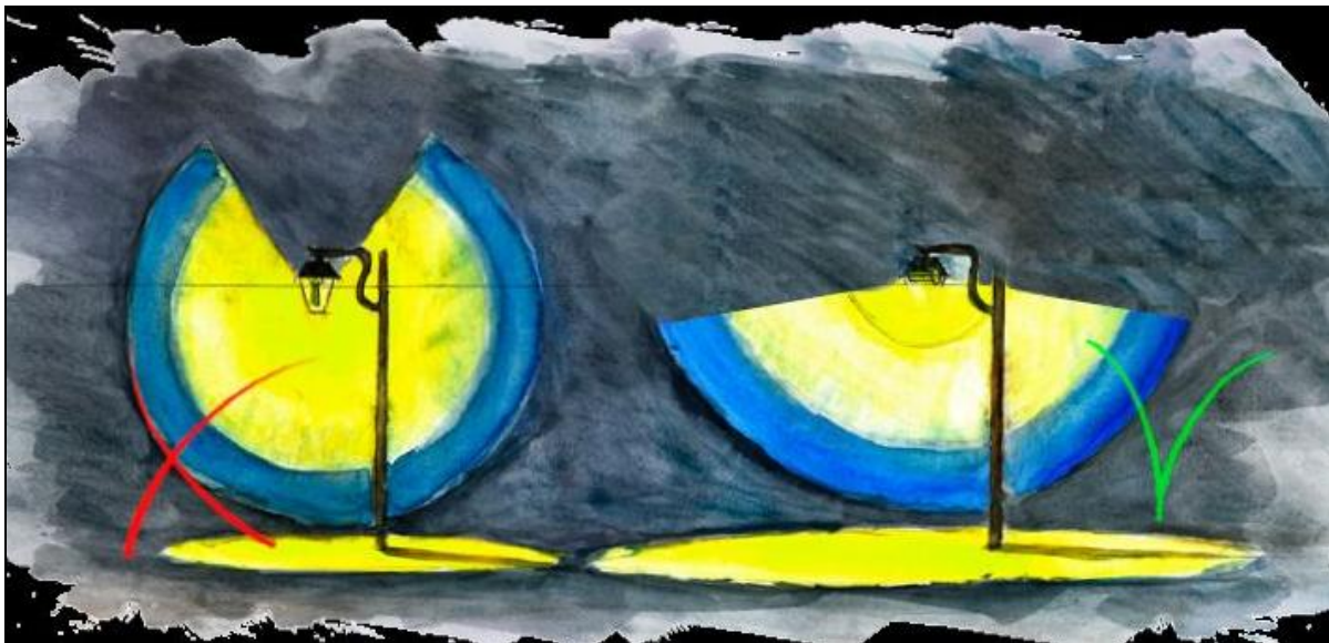
Exemples de cônes d'ombre selon la lampe (source : PNR Préalpes d'Azur)
