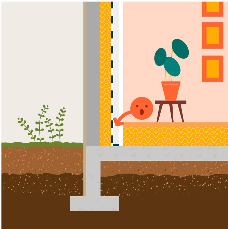
Si les murs sont isolés par l'intérieur et que le sol est isolé ultérieurement côté logement (sous chape), il y aura une discontinuité de l'isolation créée par le vide technique entre l'isolant du mur et son parement, avec un risque de condensation. Ce phénomène sera encore plus accentué et néfaste sur un plancher en bois, présentant forcément des fuites d'air parasite.
