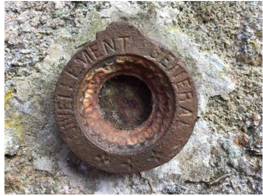
Sceau repère hauteur par rapport à la mer 33,4 mètres
