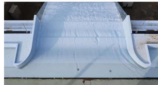
Photographie 3 : Modèle physique illustrant les écoulements à l'entonnement
