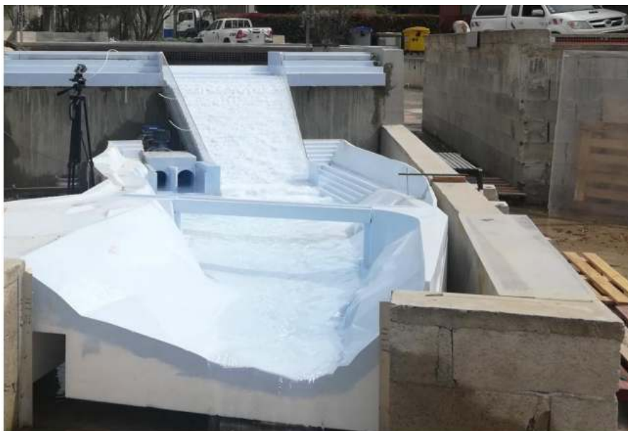
Photographie 1 : Vue sur la partie aval du modèle physique du barrage de Sainte-Cécile d'Andorge
